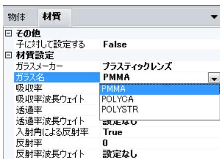
材質プロパティより、プラスティックレンズ、PMMAを指定します。
