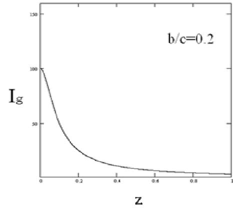
図1 (a)(b) 幾何光学照度分布  $I_g - z$
