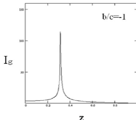
図2(c) 3次、5次収差による幾何光学照度分布  $I_g - z$
