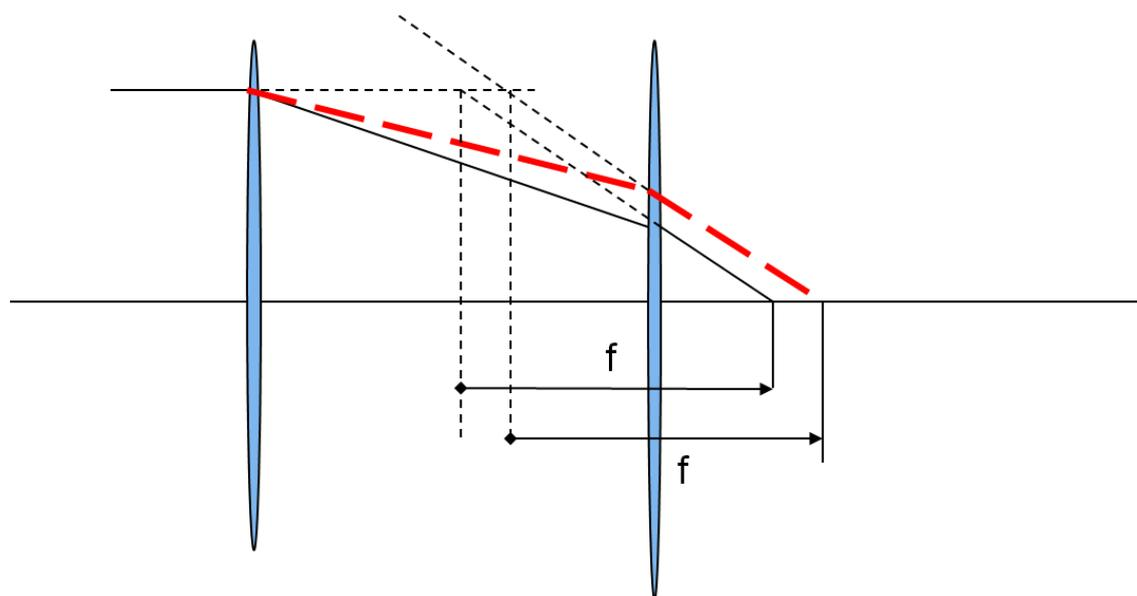
図 1 倍率の色消し 無限倍軸上光線
