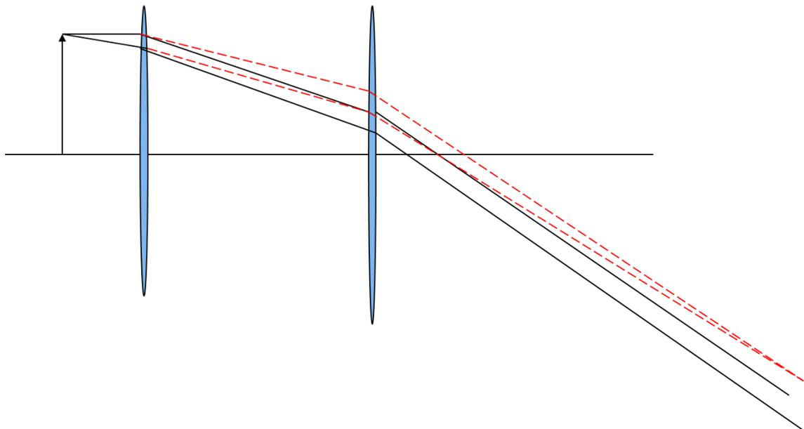
図3 倍率の色消し 光線の微小な角度のずれ
