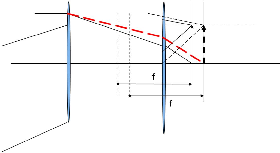
図2 倍率の色消し 無限倍軸外光線
